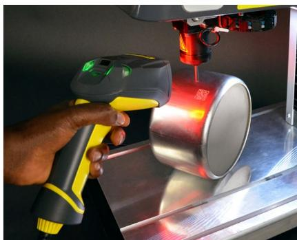
Scanner portatile per il controllo e rilettura dei codici
